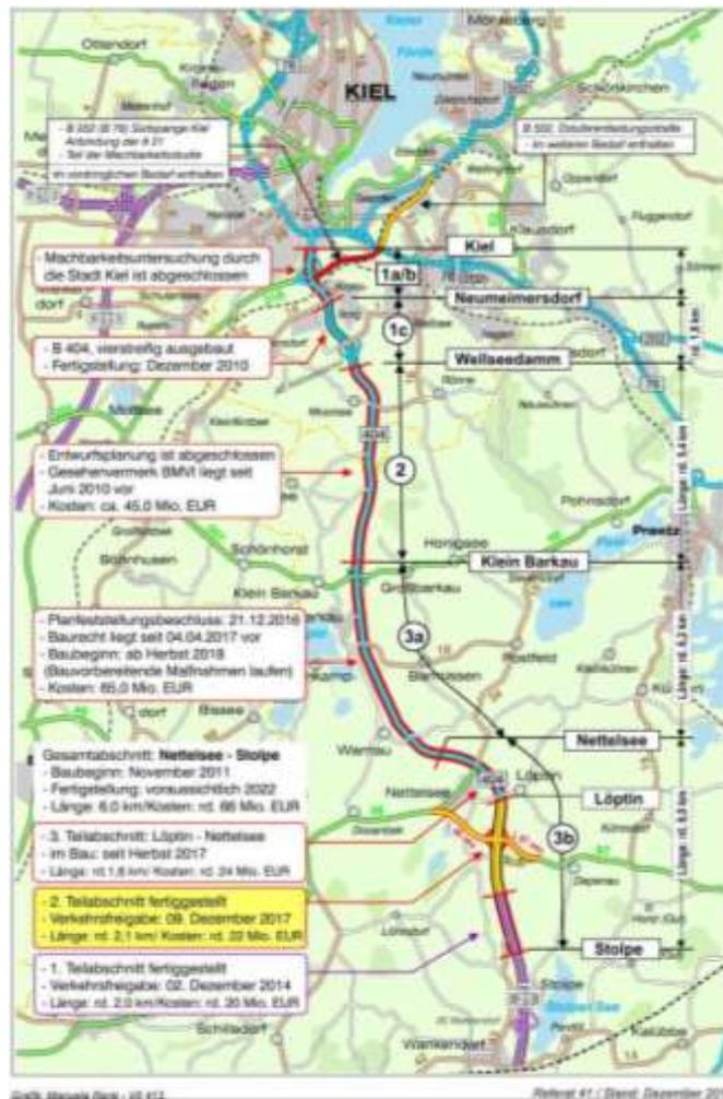
Abbildung 24: Ausbau der B 404 zur A 21 - Bauabschnitte [Quelle: Schleswig-Holstein.de, Artikel A 21 - Ausbau der B 404]
