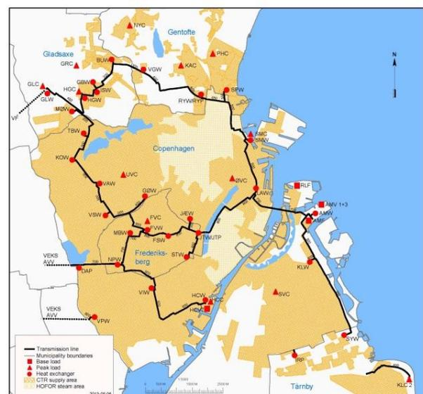
Abbildung 2: CTR-Transportnetz und HOFOR-Dampfnetzbereich
