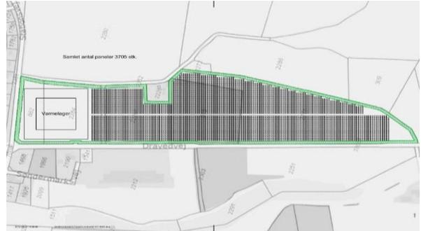
Grün umrandete Fläche: Erdbeckenwärmespeicher und Solarkollektorfeld, unterhalb Erdbeckenwärmespeicher befindet sich die bestehende Betriebsstätte <http://www.lgkfjernvarme.dk/media/225509/dias%20til%20info%20i%20Loegumgaarde.pdf>
