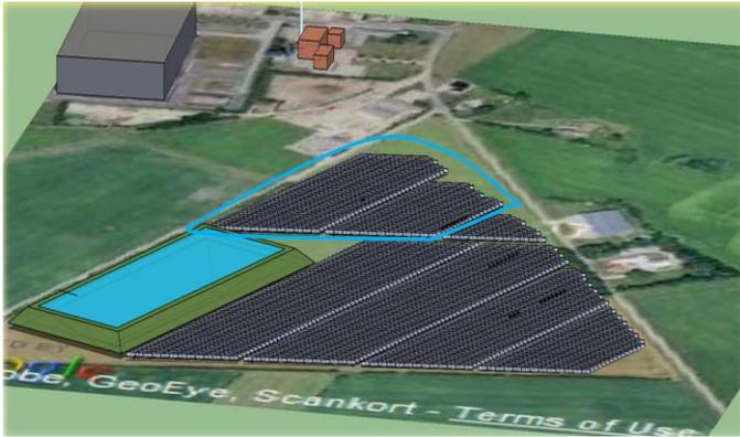
**Übersicht über die Erweiterung:** links der Erdbeckenspeicher, Mitte (blau umrandet): bestehende Solaranlage, Mitte unten: Erweiterung der Solaranlage. (Bild: Gramfjernvarme)
